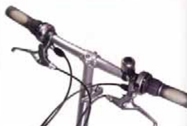
An der vorbaulosen Lenkstange sitzen Schalt-Drehgriffe
