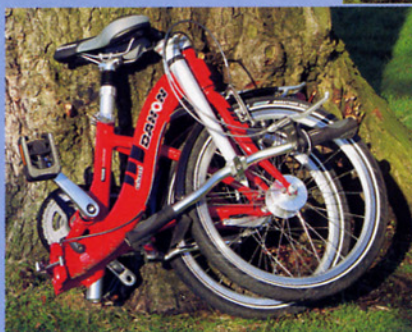
Das Dahon „Ciao“ lässt sich in etwa zehn Sekunden auf handliche Koffergröße zusammenfalten
