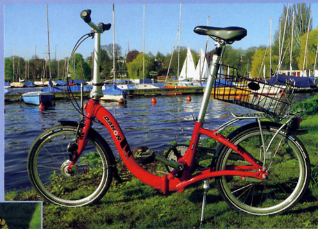
Das Dahon „Ciao“ lässt sich in etwa zehn Sekunden auf handliche Koffergröße zusammenfalten
